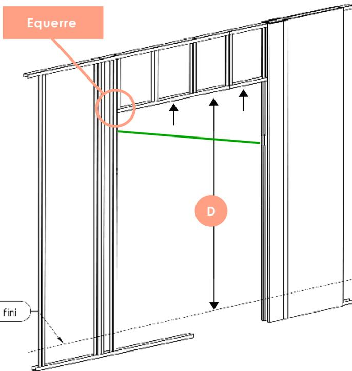
4.2 - Si nécessaire, découper le rail de guidage en aluminium à la longueur du chevêtre.
