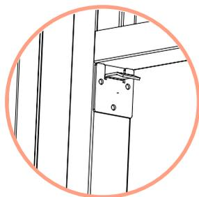
Fixer l'équerre entre le montant et le chevêtre du côté fin de course, à l'aide des vis auto-foreuse fournies.
