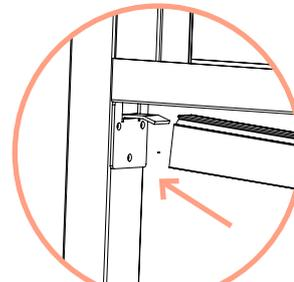
Mettre en place le rail sur l'équerre. La butée doit être positionnée à l'extrémité du côté ouverture.
