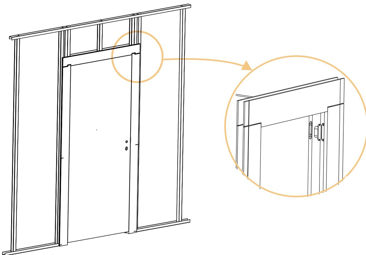
→ Préconisation : enduit sans bande CE86 avec un fixateur (type Tiefengrund).
