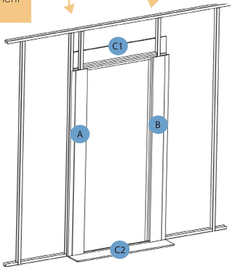
3 Régler la verticalité, l'aplomb et l'altimétrie du module B (montant serrure).
